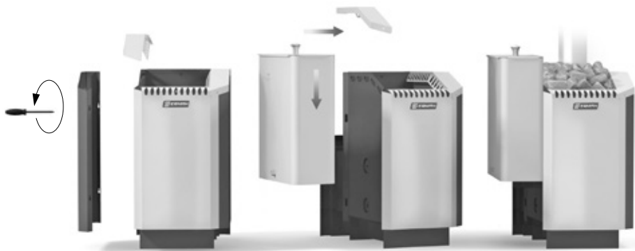
Рисунок-11. Схема установки навесного бака
