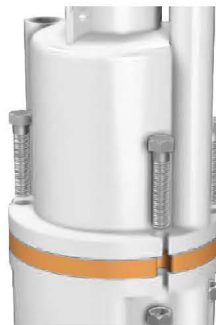
Открутите гайки на корпусе
