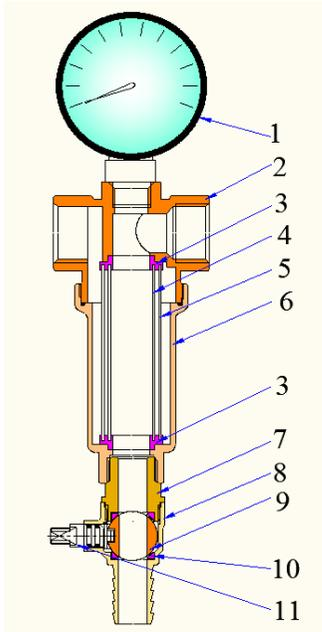
Фильтр состоит из корпуса 2 и колбы 6, выполненных из горячештампованной латуни CW617N с гальванопокрытием из никеля. Между собой корпус и колба соединены на резьбе с кольцевой прокладкой из EPDM.
